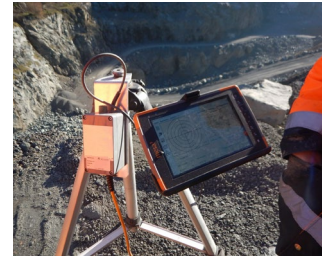
10 a+b: EDV-gestützte Bohrlochvermessung mit einer Bohrlochsonde - Aufstellung der Bohrlochsonde (Quelle: RP Darmstadt)
