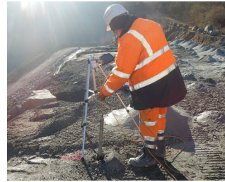
10 a+b: EDV-gestützte Bohrlochvermessung mit einer Bohrlochsonde - Aufstellung der Bohrlochsonde (Quelle: RP Darmstadt)
