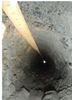
Überprüfung Richtung und Neigung eines Bohrloches inkl. Blick in das Bohrloch (Quelle: RP Darmstadt)
