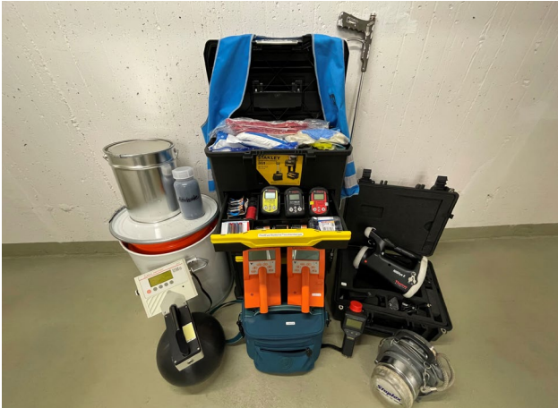
Ausrüstung der Strahlenschutzfachkräfte. Links: Bergebehälter, Mittig: Koffer mit Schutzausrüstung. In offener Schublade: Dosisleistungsmessgeräte, zur Suche nach radioaktiven Stoffen und zur Messung der erhaltenen Dosis. Darunter (Orange): Kontaminationsnachweisgeräte. Rechts: Gammaskontaminationsmessgerät zur Nuklididentifikation. (Quelle: RP Darmstadt)
