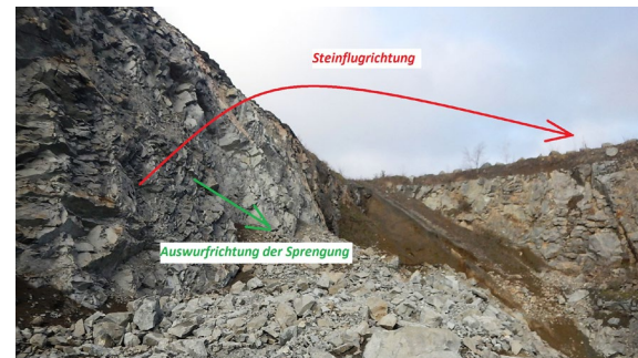
Sprengstelle mit Steinflugrichtung und Auswurfriechung der Sprengung (Quelle: RP Darmstadt)
