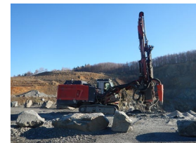
Terrassen in einem Steinbruch (Quelle: RP Darmstadt) Bohren der Sprenglöcher (Quelle: RP Darmstadt)
