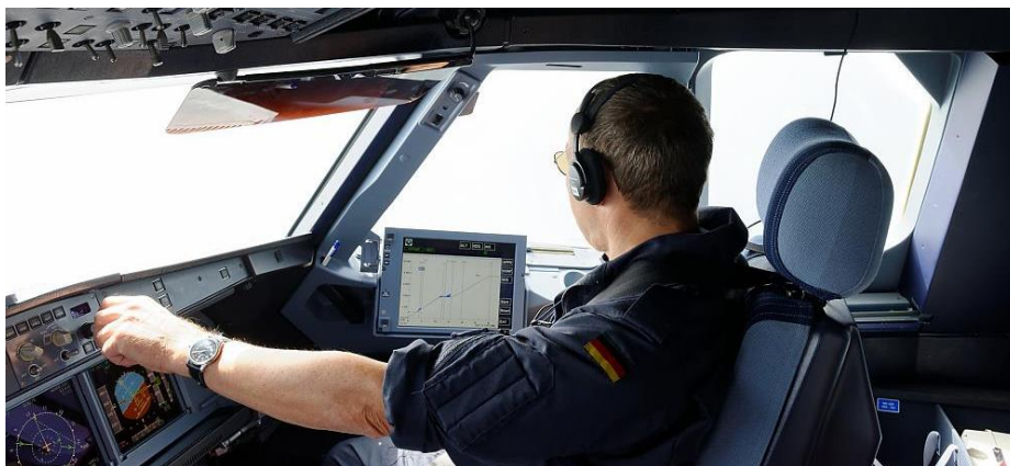
Abbildung 42: Cockpit mit Assistenzsystem LNAS © UNH 206
