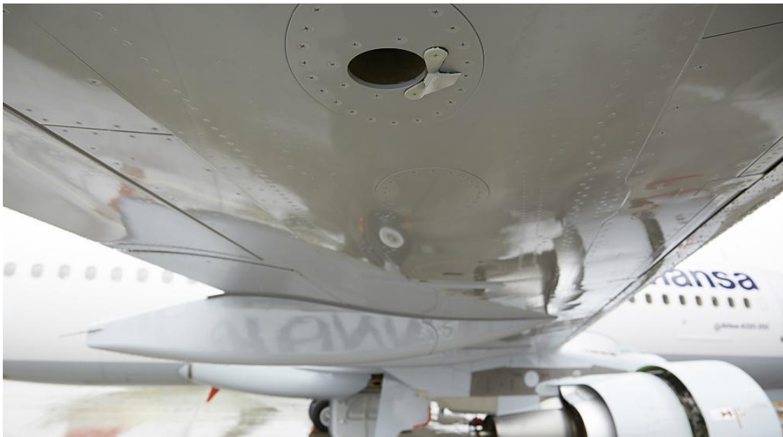
Abbildung 63: Ein Wirbelgenerator an der Tankdruckausgleichsöffnung montiert ©UNH 337
