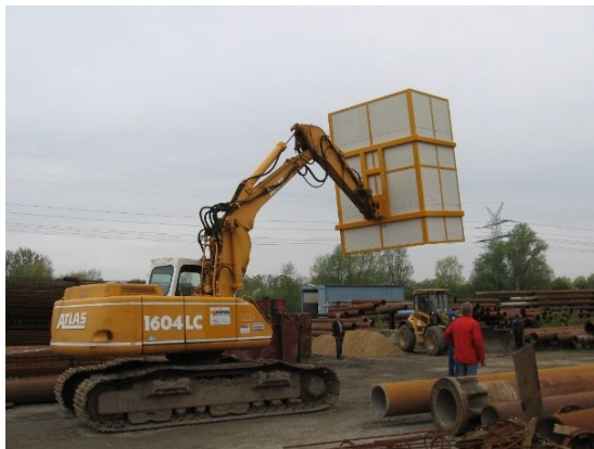
Abbildung 4. Mobile dreiseitige Abschirmwand für eine Ramme.
