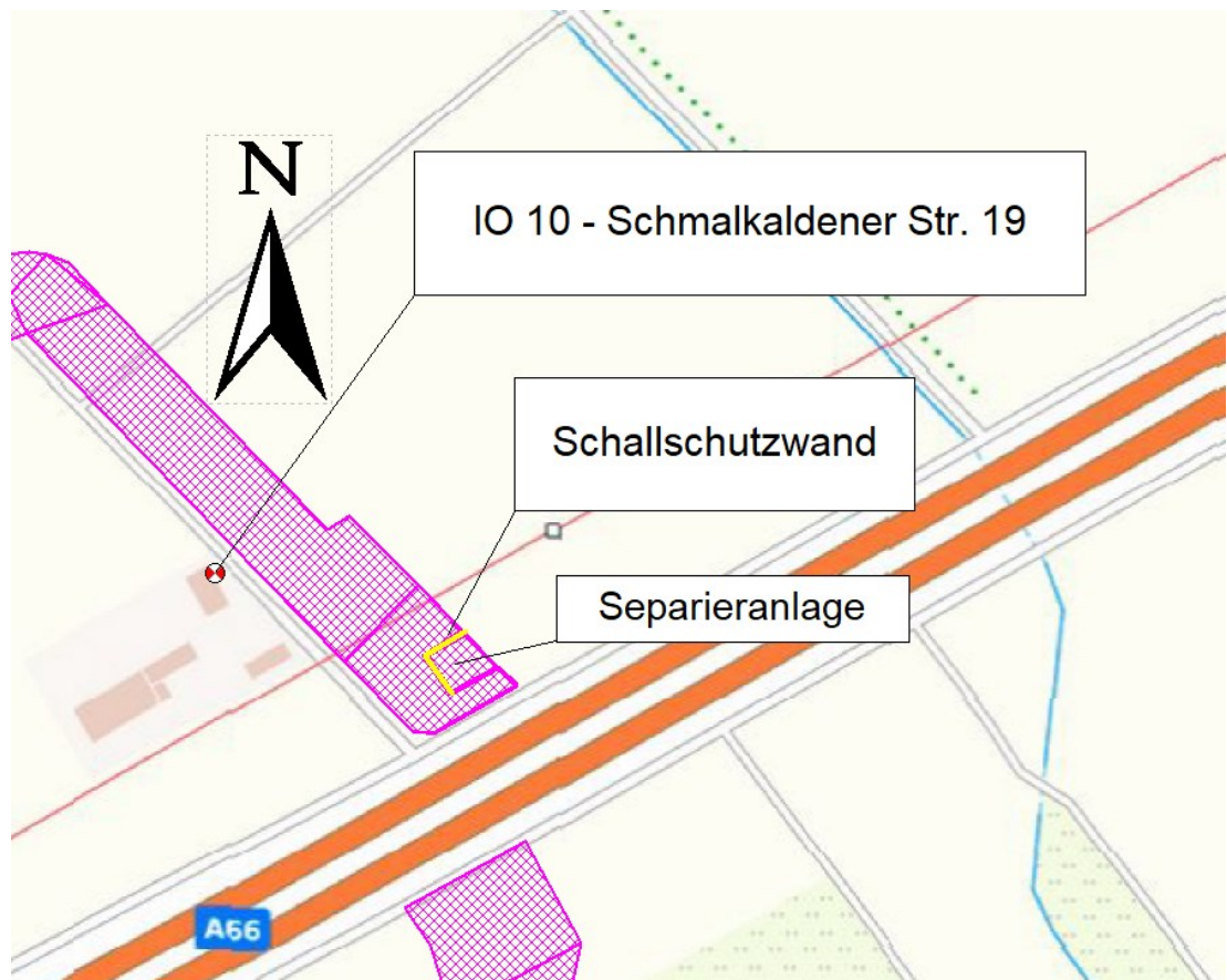
Abbildung 1. Anordnung der Lärmschutzwand an der Separieranlage beim Rohrvortrieb zur Querung der A66 (L-förmig, Schenkellänge jeweils mind. 15 m).
